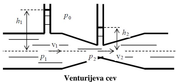
Venturijeva cev se satoji od cevi sa suženjem tako da se izbegne turbulentno (vrtložno) kretanje tečnosti i ometnutih vertikalnih cevi na širem delu cevi i na suženju.
