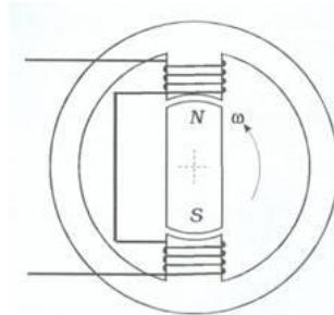
**Generator naizmenične struje sa magnetom na rotoru**
