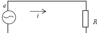
**Kolo naizmenične struje sa otpornikom**
